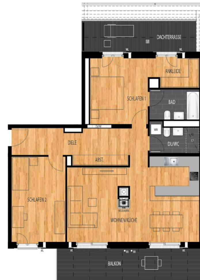
WM = Waschmaschinen-Anschluss WL = Wohnraumlüfter HV = Heizungsunterverteilung
