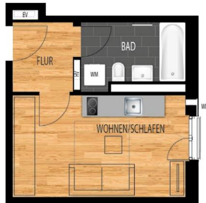
WM = Waschmaschinen-Anschluss WL = Wohnraumlüfter HV = Heizungsunterverteilung
