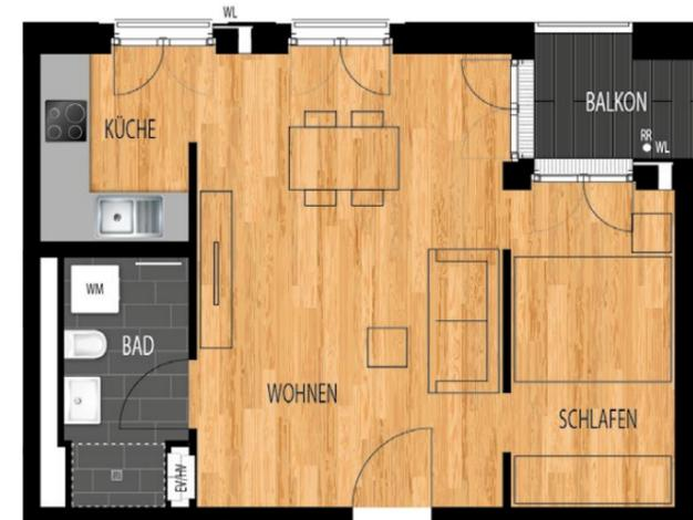
WM = Waschmaschinen-Anschluss WL = Wohnraumlüfter HV = Heizungsunterverteilung
