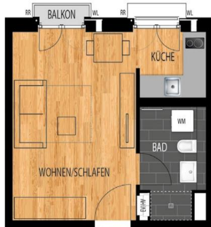
WM = Waschmaschinen-Anschluss WL = Wohnraumlüfter HV = Heizungsunterverteilung
