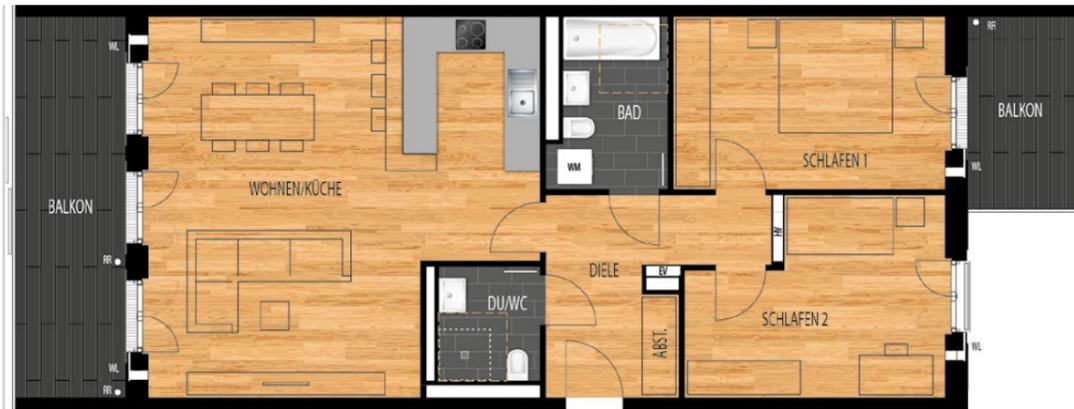
WM = Waschmaschinen-Anschluss WL = Wohnraumlüfter HV = Heizungsunterverteilung
