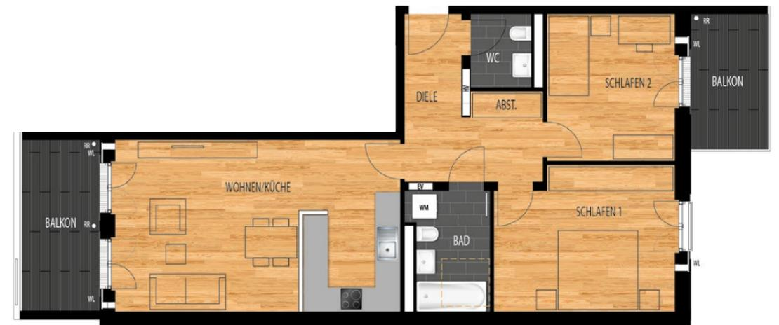
WM = Waschmaschinen-Anschluss WL = Wohnraumlüfter HV = Heizungsunterverteilung
