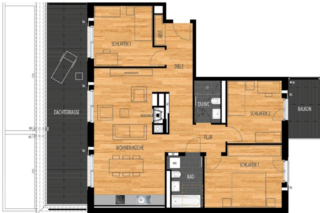
WM = Waschmaschinen-Anschluss WL = Wohnraumlüfter HV = Heizungsunterverteilung
