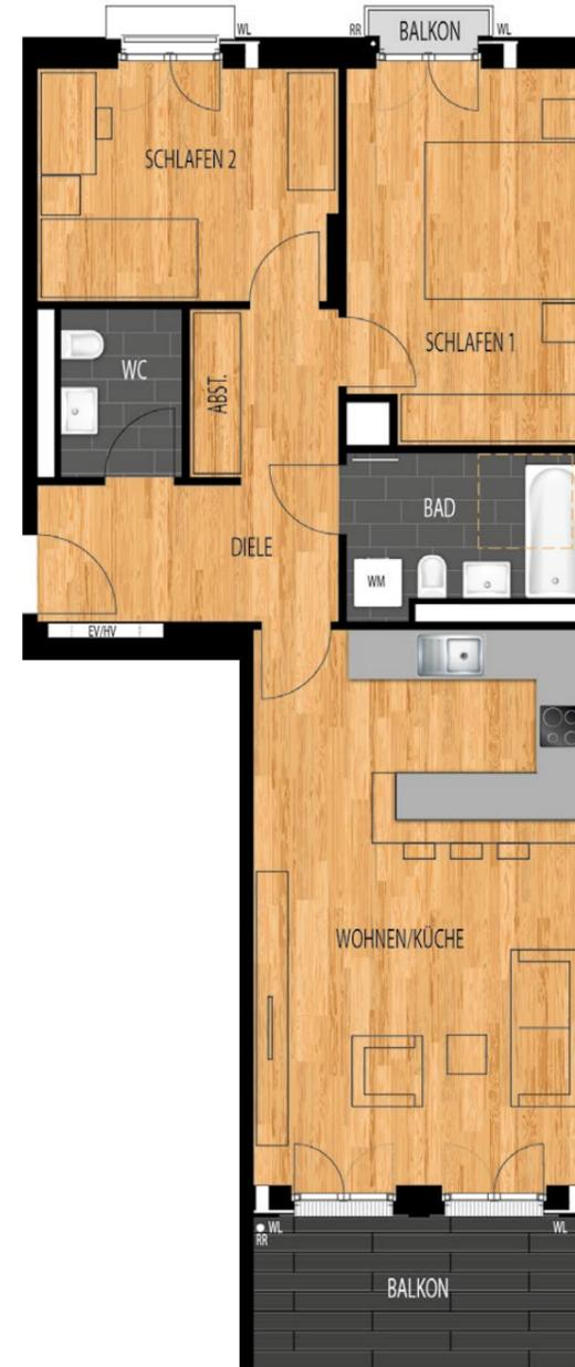
WM = Waschmaschinen-Anschluss WL = Wohnraumlüfter HV = Heizungsunterverteilung
