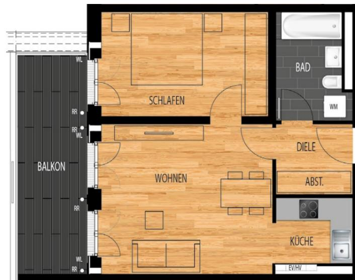
WM = Waschmaschinen-Anschluss WL = Wohnraumlüfter HV = Heizungsunterverteilung
