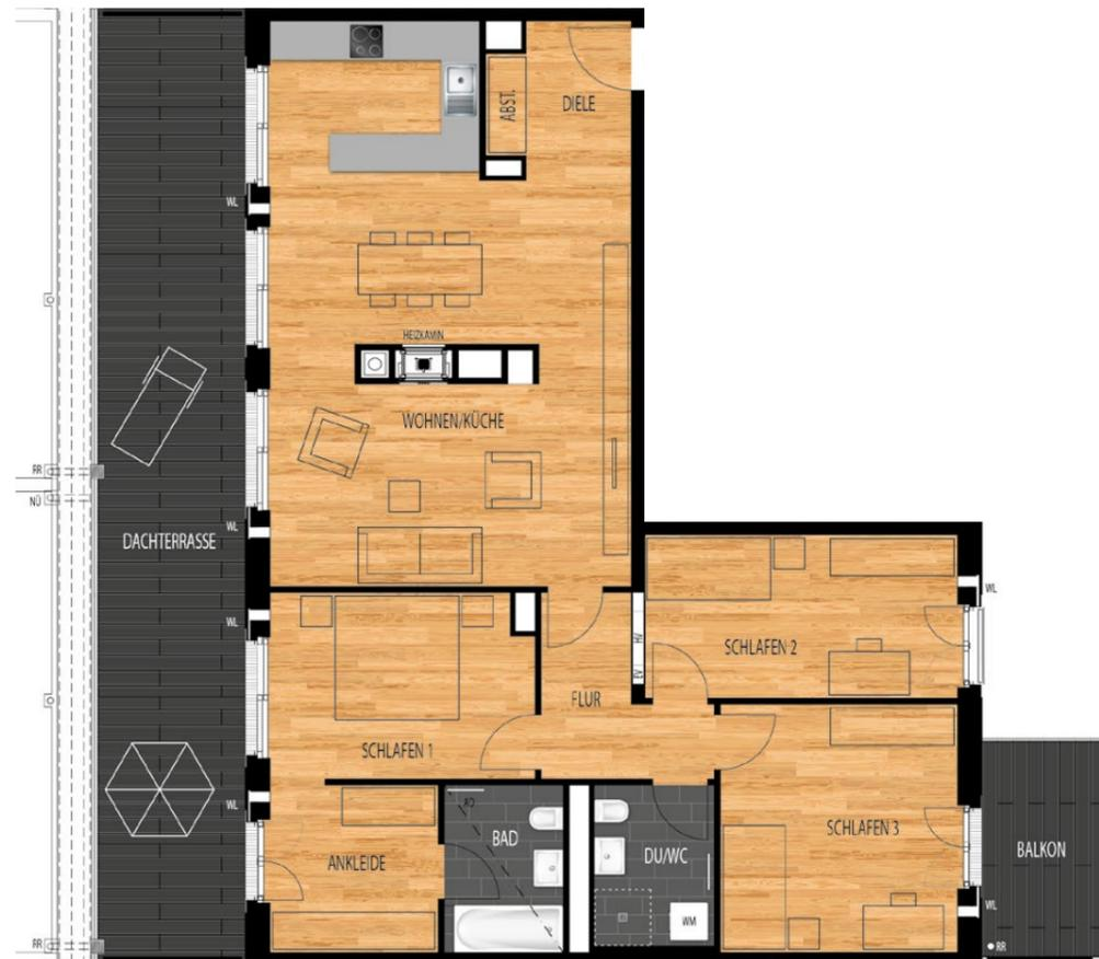
WM = Waschmaschinen-Anschluss WL = Wohnraumlüfter HV = Heizungsunterverteilung
