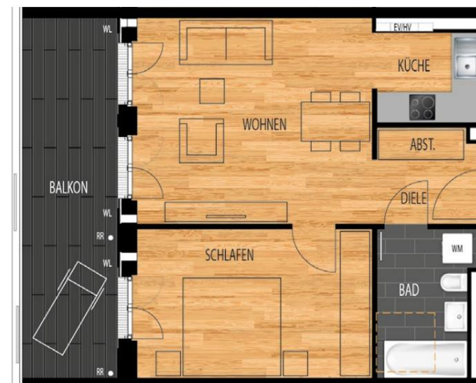
WM = Waschmaschinen-Anschluss WL = Wohnraumlüfter HV = Heizungsunterverteilung
