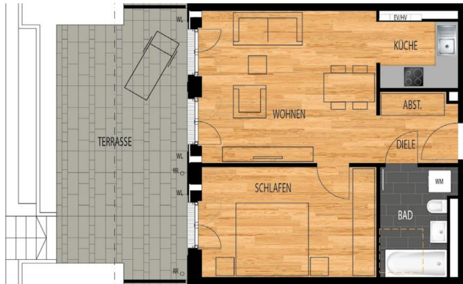
WM = Waschmaschinen-Anschluss WL = Wohnraumlüfter HV = Heizungsunterverteilung
