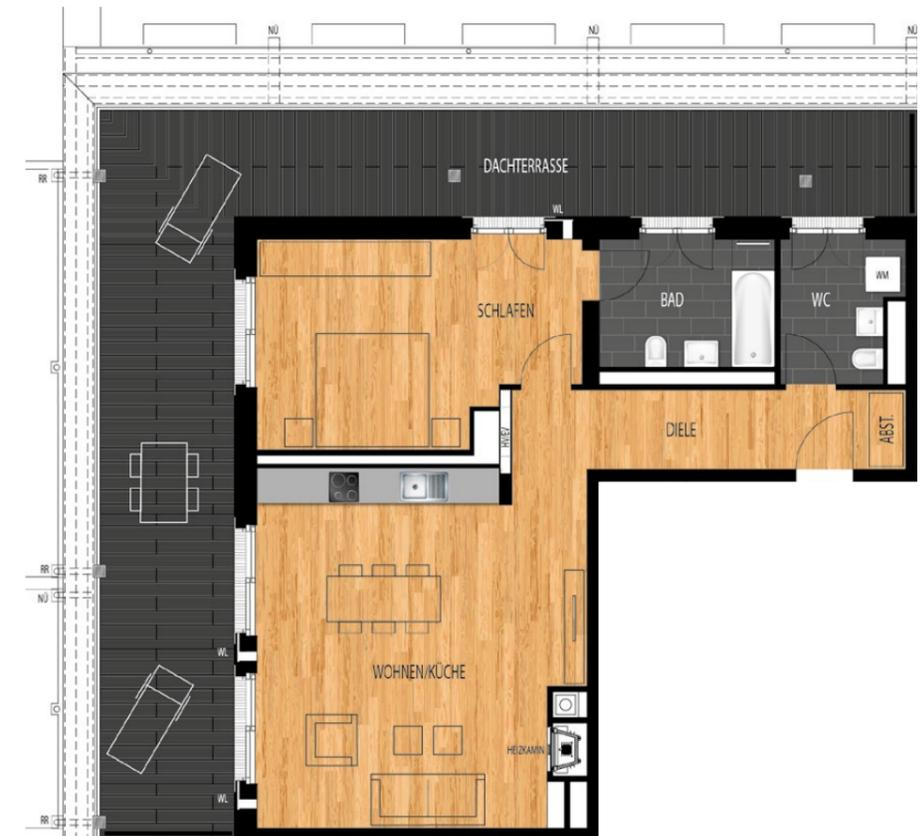
WM = Waschmaschinen-Anschluss WL = Wohnraumlüfter HV = Heizungsunterverteilung
