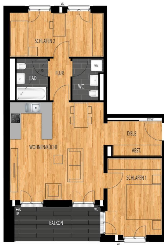
WM = Waschmaschinen-Anschluss WL = Wohnraumlüfter HV = Heizungsunterverteilung
