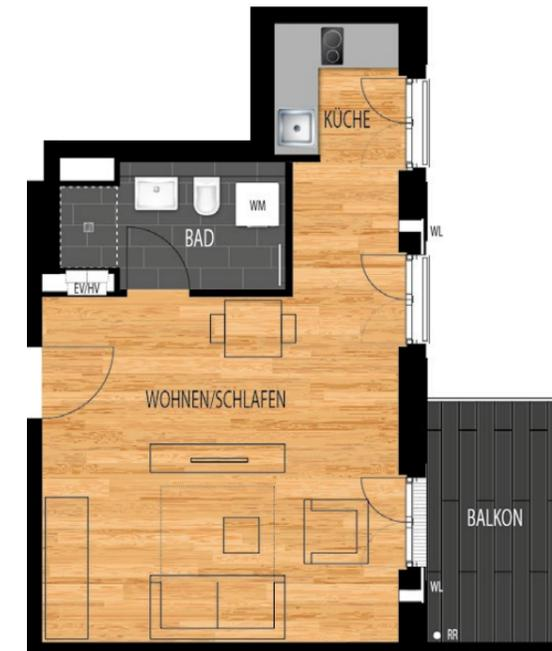
WM = Waschmaschinen-Anschluss WL = Wohnraumlüfter HV = Heizungsunterverteilung
