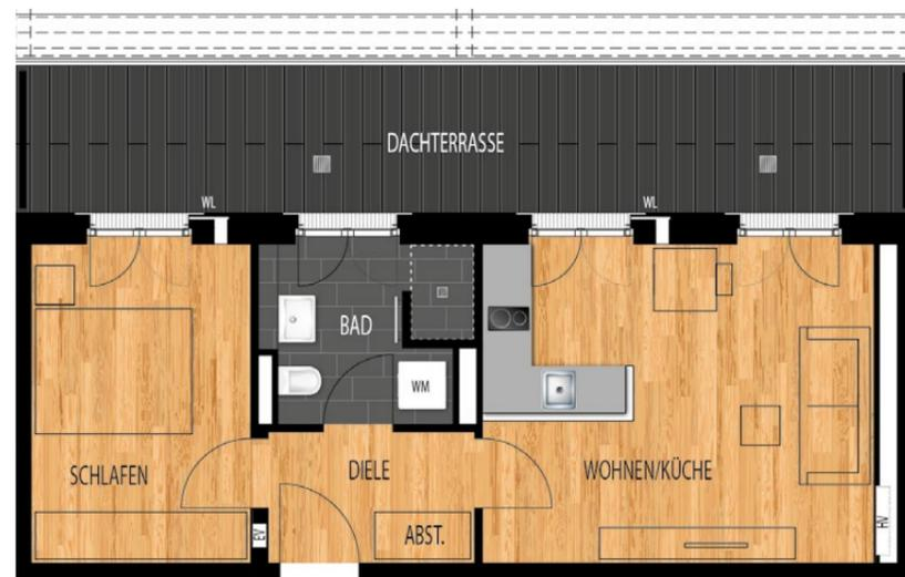
WM = Waschmaschinen-Anschluss WL = Wohnraumlüfter HV = Heizungsunterverteilung
