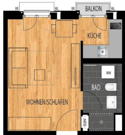
WM = Waschmaschinen-Anschluss WL = Wohnraumlüfter HV = Heizungsunterverteilung
